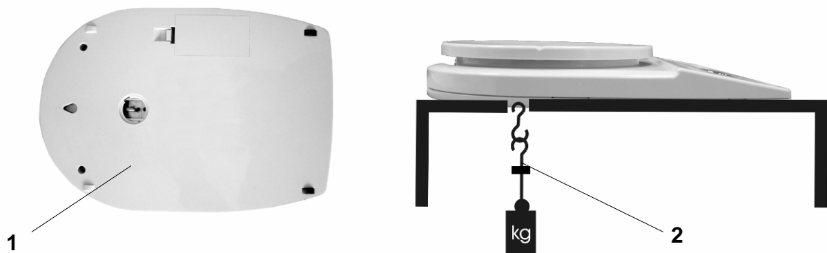
Billede 1: Opstilling af en vægt til vejning under gulvet
